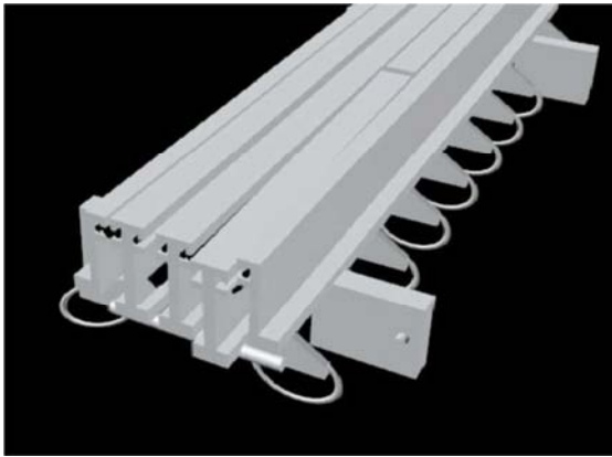
图6 模数式伸缩缝模拟开裂。
