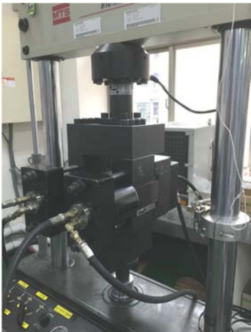
图4 剪力试验夹具图。
