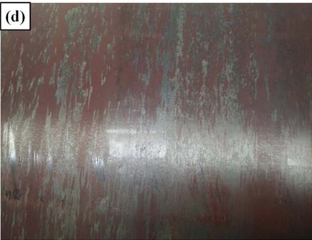
(a) 1#试样, K52; (b) 2#试样, K52; (c) 3#试样, X52; (d) K52宏观氧化铁皮
