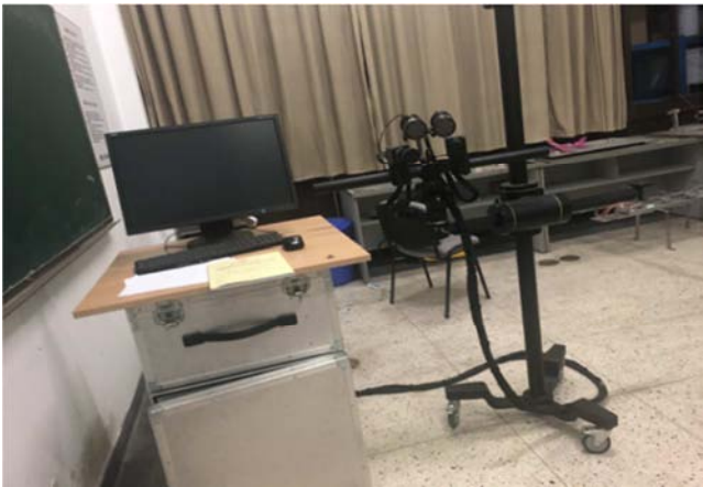
图2 DIC数字图像测量系统。
