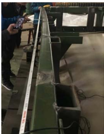
图2 张拉膜试验后框架明显变形。
